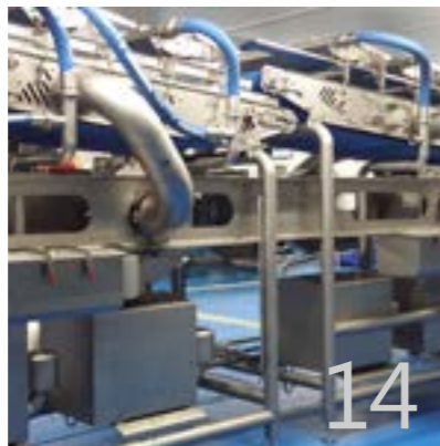
Foodlife: Ventilatoren blazen sla droog.
